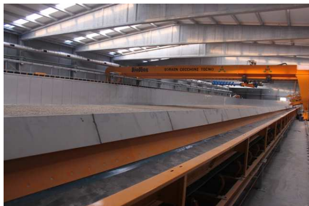
Cinta de sortida de material del reactor.
